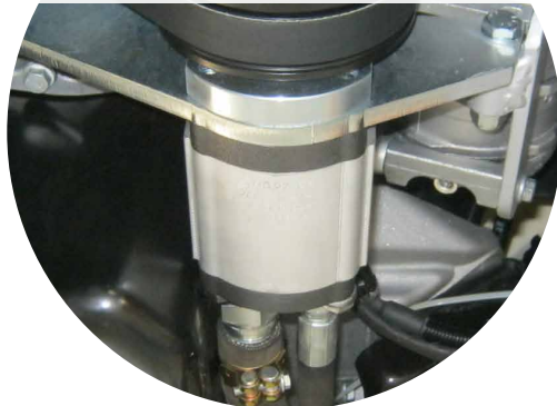
Nebenantrieb mit elektro Kupplung
