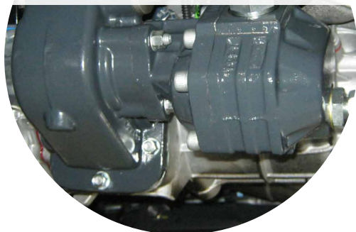
Nebenantrieb, der mit dem Getriebe des Fahrzeuges verbunden ist
