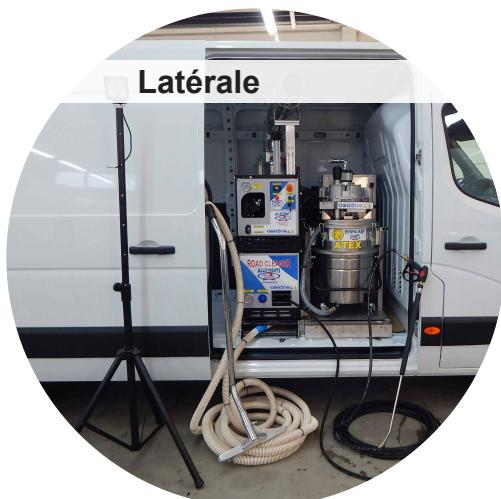
L'installation latérale du système permet de s'approcher au lieu à restaurer avec le côté du véhicule, et même de distribuer le poids du module centralement. La partie postérieure du compartiment de chargement reste libre pour le transport d'outils et de plusieurs types d'accessoires.
