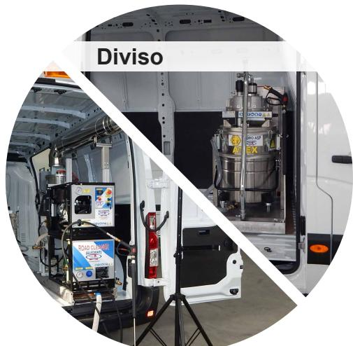
L'installazione divisa permette di avvicinarsi al luogo da ripristinare con il retro del veicolo e facilita la salita e la discesa del personale dal mezzo da entrambe le porte. La suddivisione dei pesi è ottimizzata, in quanto il serbatoio di acqua è posizionato nella parte centrale del veicolo e il gruppo di lavoro nella parte posteriore. La parte rimanente del vano di carico è utilizzabile per stoccare attrezzi e accessori vari.
