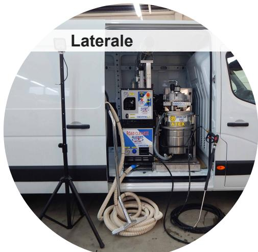
L'installazione laterale del sistema permette di avvicinarsi al luogo da ripristinare con il fianco del veicolo, oltre a distribuire il peso del modulo centralmente. La parte posteriore del vano di carico rimane libera per il trasporto di attrezzi e accessori vari.
