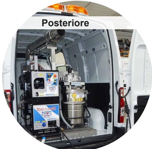
L'installazione del sistema sulla parte posteriore permette di avvicinarsi al luogo da ripristinare con il retro del veicolo e avere la parte anteriore del vano di carico libera per attrezzi e accessori vari.
