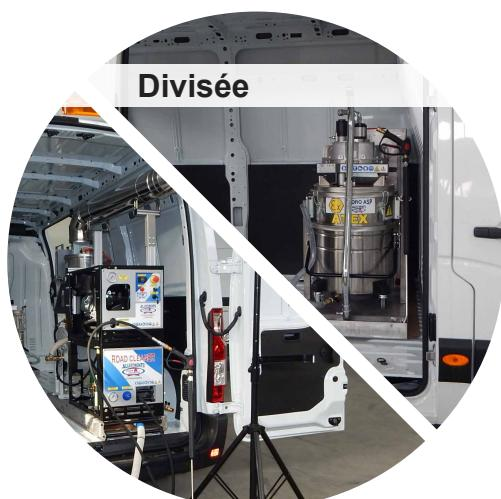
L'installation divisée permet de s'approcher au lieu à restaurer avec l'arrière du véhicule et facilite la montée et la descente du personnel du moyen, de toutes les deux les portes. La subdivision des poids est optimisée, car le réservoir d'eau est placé dans la partie centrale du véhicule et le groupe de travail dans la partie postérieure. On peut utiliser la partie restante du compartiment de chargement pour stocker des outils ou plusieurs types d'accessoires.
