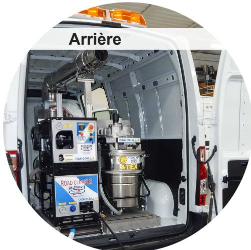
L'installation du système sur la partie arrière permet de s'approcher au lieu à restaurer avec l'arrière du véhicule et d'avoir la partie antérieur du compartiment de chargement libre pour des outils et plusieurs types d'accessoires.
